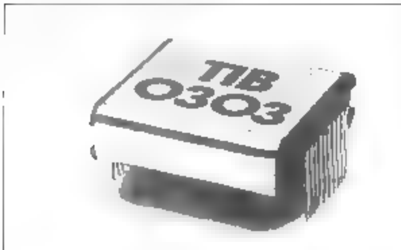
Photo 2 — Le TIB 0303 a une capacité de 2048 bits
